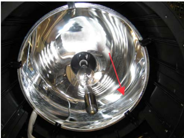
7. Entfernen Sie ganz vorsichtig den Glasreflektor
