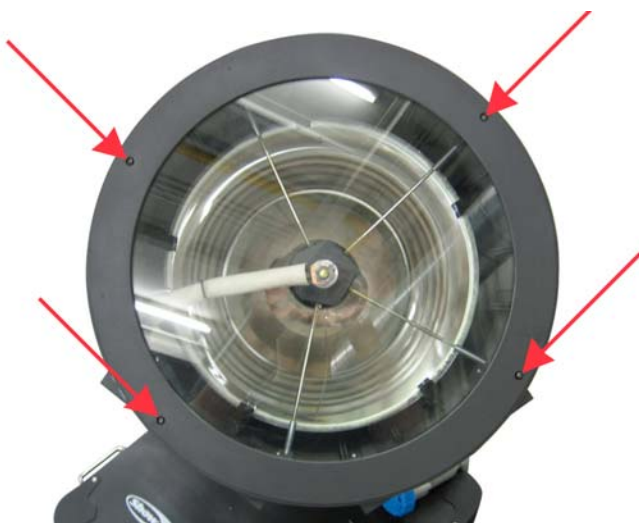
1. Entfernen Sie die 4 Schrauben
