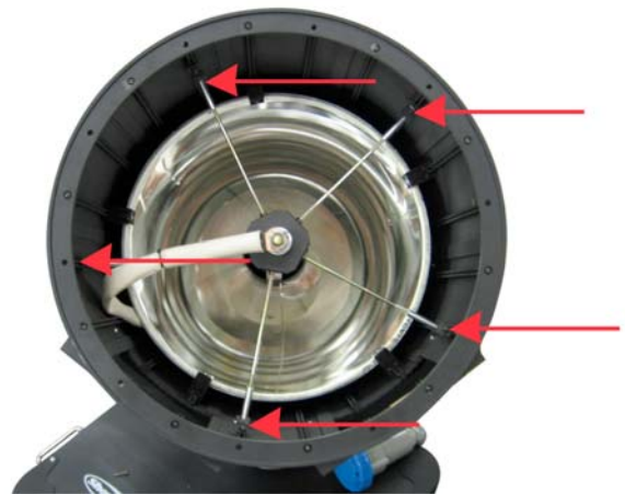
4. Entfernen Sie alle 5 Lampenbügel.
