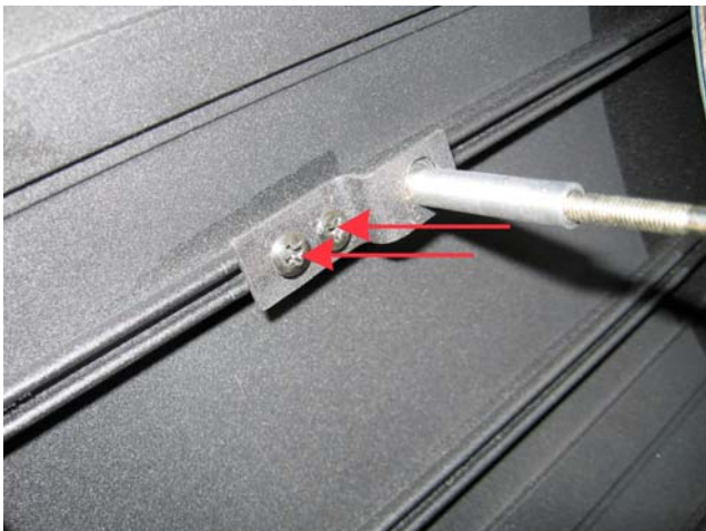
5. Lösen Sie die 2 Schrauben, um die Bügel zu entfernen.
