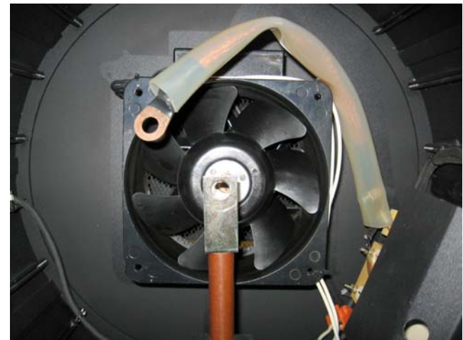
8. Die Schraube auf der Rückseite der Lampe kann jetzt entfernt werden und Sie können die Lampe herausnehmen.
